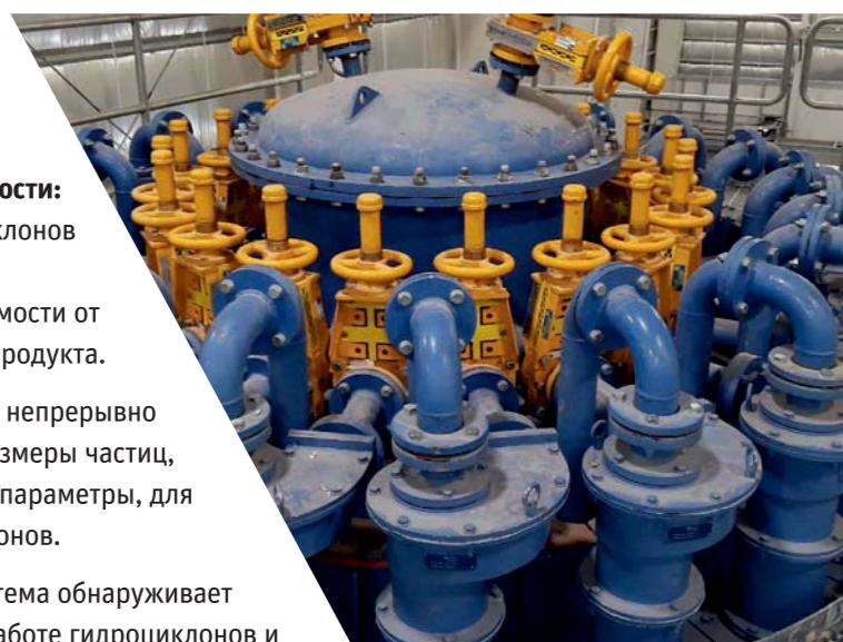
**Мониторинг и контроль параметров:** Система непрерывно мониторит параметры процесса, такие как размеры частиц, расход жидкости, давление и другие важные параметры, для обеспечения оптимальной работы гидроциклона.
